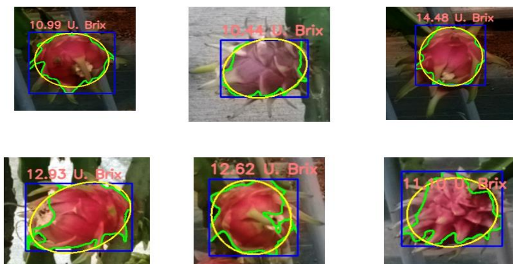
Figura 5: Ejemplo de estimación de la calidad de los frutos por el sistema integrado en el prototipo robot basado en análisis de imagen en condiciones de campo.
