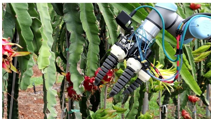
Figura 2: Colocación de la cámara en el brazo y garra robótica.
