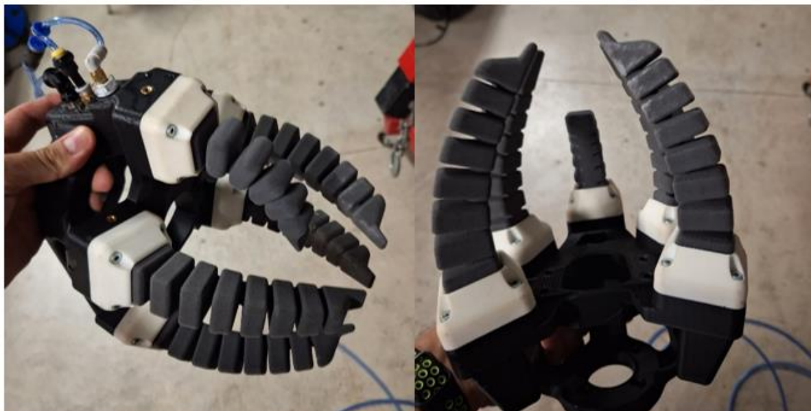
Figura 7: Primeras pruebas de garra con chasis con circuitos integrados
